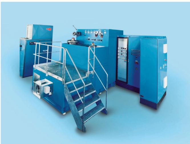
Prüfstand zur Ermittlung des Druckverlustes
