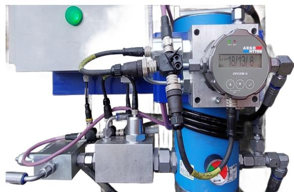
Beispiel eines Überwachungssystems mit OCom-Partikelmonitor und LubCos H2O.
