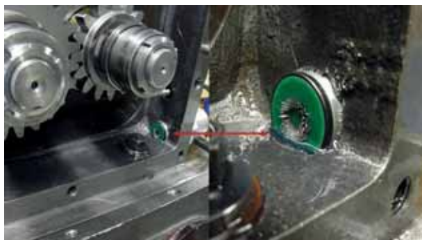
Převodovka s vestavěným snímačem opotřebení OPCOM FerroS a zachycenými částicemi
