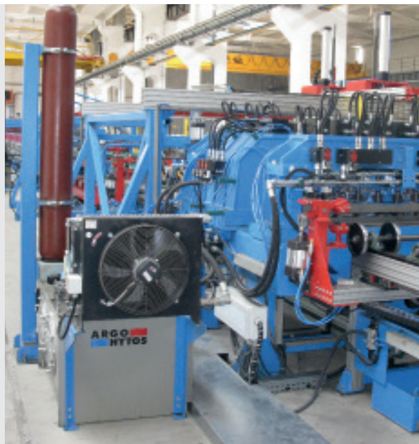
Výrobní linka pro děrování plechu, poháněná hydraulickými systémy, které byly vyvinuty, zkonstruovány a uvedeny do provozu týmem ARGO-HYTOS Polsko.
