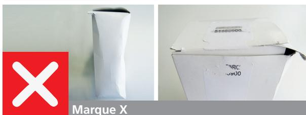
Un **emballage impropre** provoque l'**encrassement et l'endommagement de l'élément**. L'**absence du film de protection** provoque l'encrassement, plus particulièrement pour des éléments en fibre de verre. Des **cartons** avec une **faible épaisseur de paroi** sont fragiles. Ainsi des cartons ou même des éléments sont abîmés lors du transport ou du stockage. **Sans étiquettes de sécurité**, l'état du produit neuf / emballé ne peut pas être garanti.
