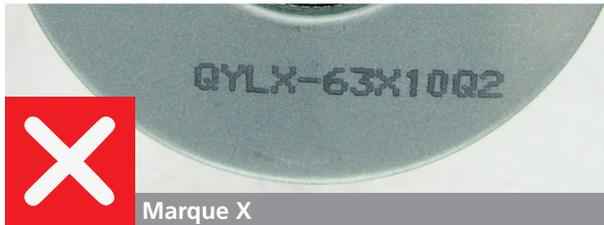
Un **marquage insuffisant du produit** rend son identification impossible même après une durée d'utilisation réduite. L'**encre** utilisée pour le marquage des coupelles **n'est généralement pas résistante à l'huile et s'efface** après une courte durée d'utilisation. **Le marquage est entièrement manquant** dans la plupart des cas.
