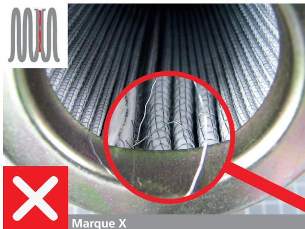
La **fixation manquante** des **extrémités du maillage** provoque des **fuites** et un **détachement des fils et des fibres**. Les **extrémités du maillage** sont seulement **collées ensemble par les lamelles** et non entièrement enserrées avec de la colle.
