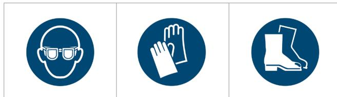
Bei der Arbeit mit der Hydraulikflüssigkeit wird es empfohlen, Schutzbrille, Gummihandschuhe und festes Schuhwerk mit rutschfester Sohle zu tragen.
