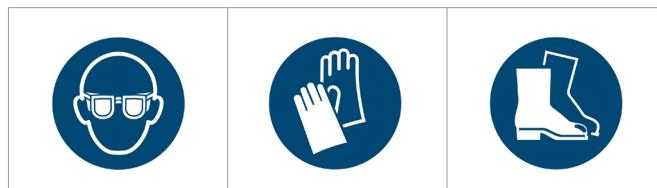
Bei Arbeiten mit der hydraulischen Flüssigkeit wird empfohlen, die Schutzbrille, Gummihandschuhe und festes Schuhwerk mit rutschfesten Sohlen zu tragen.
