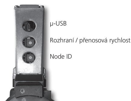
Obrázek 7-8: Uspořádání a popis otočného přepínače
