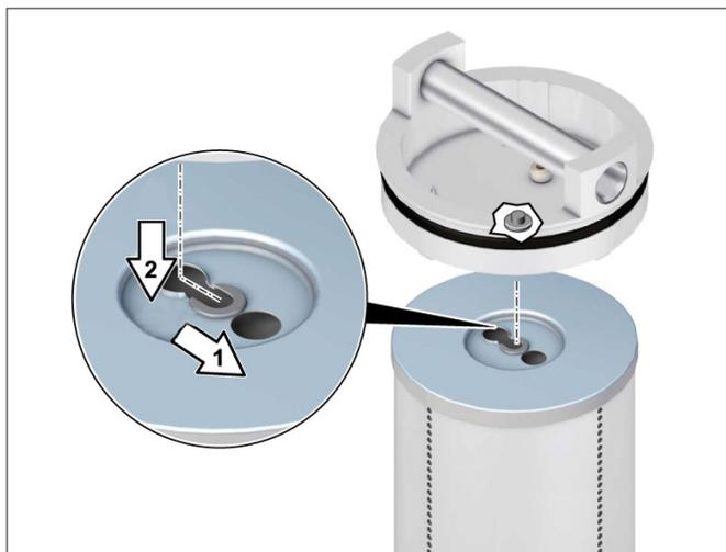
Abb. 33: Filterelement abnehmen
