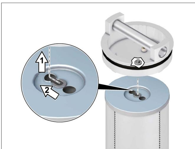
Abb. 34: Filterelement einhängen
