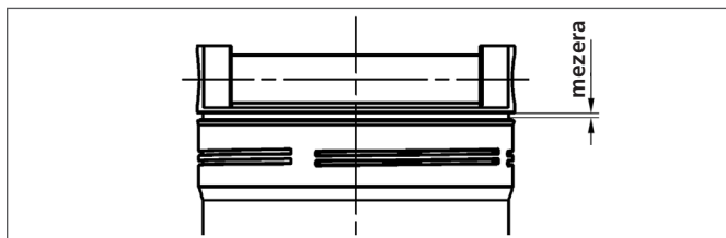
Obr. 36: Mezera mezi víkem a tělesem filtru
