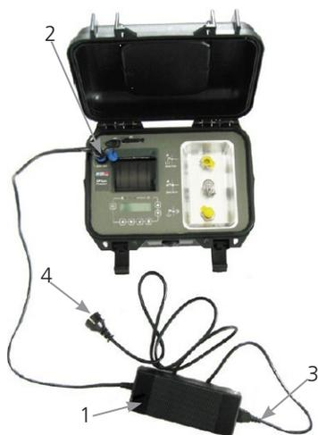
Abb. 12: Elektrischer Anschluss
