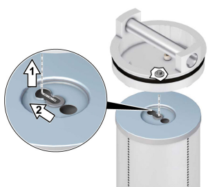
Obr. 7: Připojení filtrační vložky k víku
