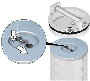
Abbildung 6: Filterelement abnehmen
