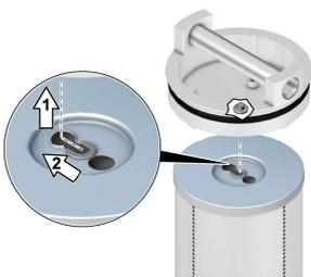
Abbildung 7: Filterelement einhängen
