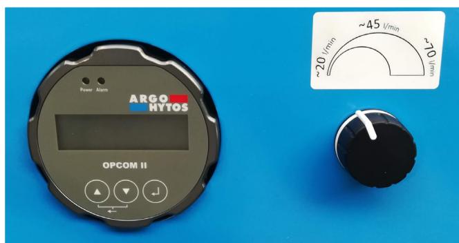
Čelní panel UMPCL 045 Lightline s nastavitelným průtokem
