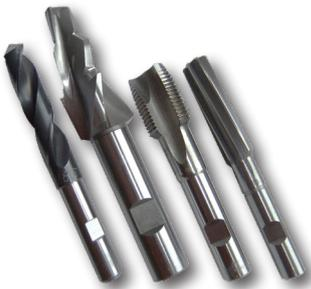
Významným prvkem pro správnou funkci vestavných ventilů jsou komory pro jejich montáž do bloku. Jejich funkce závisí jak na dodržení rozměrů, tak správné geometrii komor. Tyto požadavky lze technologicky splnit jen při použití speciálních sdrúžených nástrojů, vyráběných na zakázku z rychlořezné oceli. Přehled nástrojů pro obrábění komor najdete v katalogu SMT 0019.
