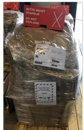
Hydraulické bloky a agregáty jsou baleny tak, aby byla zajištěna jejich ochrana proti mechanickému poškození, znečištění a korozi při dopravě. Pro lodní přepravu jsou používány speciální obaly, obsahující inhibitory koroze VpCI (Vapor phase Corrosion Inhibitors). Existuje také celá řada typů balení na přání zákazníků. Veškeré používané obalové materiály jsou recyklovatelné a nezatěžují životní prostředí.
