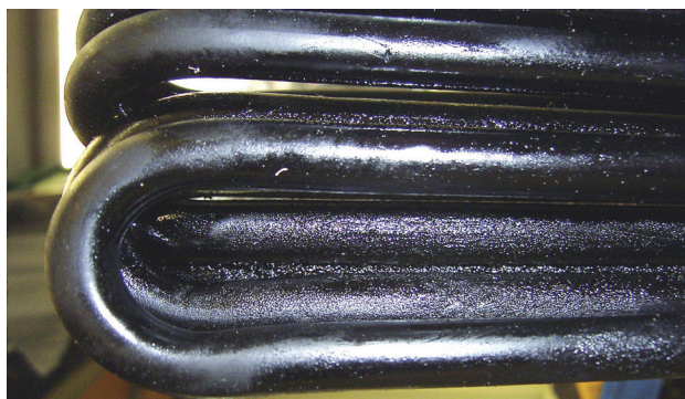
Produkty stárnutí oleje na svazcích trubek chladiče oleje
