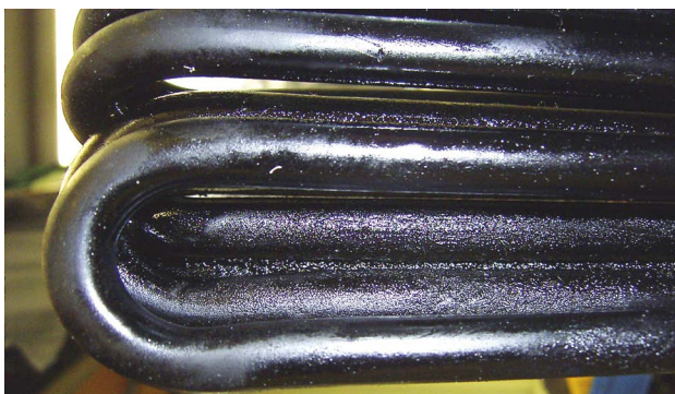
油老化的产品在油冷却器管里bundels
