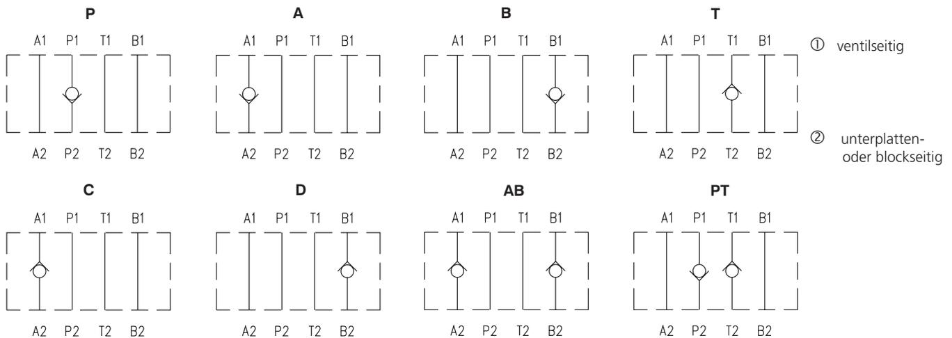
Hinweis: Die Orientierung der Symbole auf dem Typenschild korrespondiert mit der Ventilfunktion.
