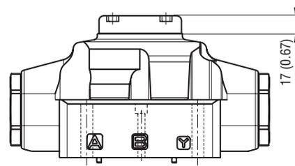
Bei kleinen Volumenströmen kann der Steuerdruck bis 5 bar tief sein. Für höhere Volumenströme sind jedoch 12 bar erforderlich.
