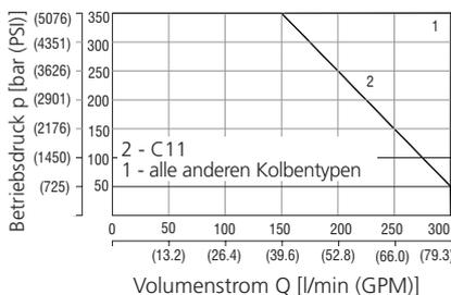
**Druckverlust in Abhängigkeit vom Volumenstrom**
