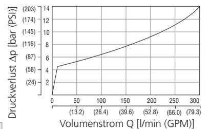
Die Kurve bezieht sich auf den Druckverlust (nur Gehäuse) mit eingesetztem Gegendruckventil, welcher zum Druckverlust des Kolbens hinzugerechnet werden muss.
