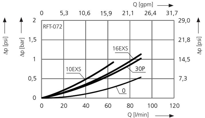
**Kennlinien für die Filtereinheiten**
