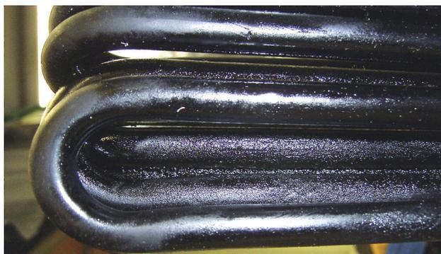
Ölalterungsprodukte auf Rohrbündel eines Ölkühlers
